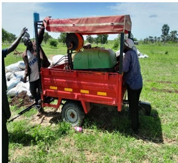
**Photo 29** : Epandeur d'engrais liquide testé
