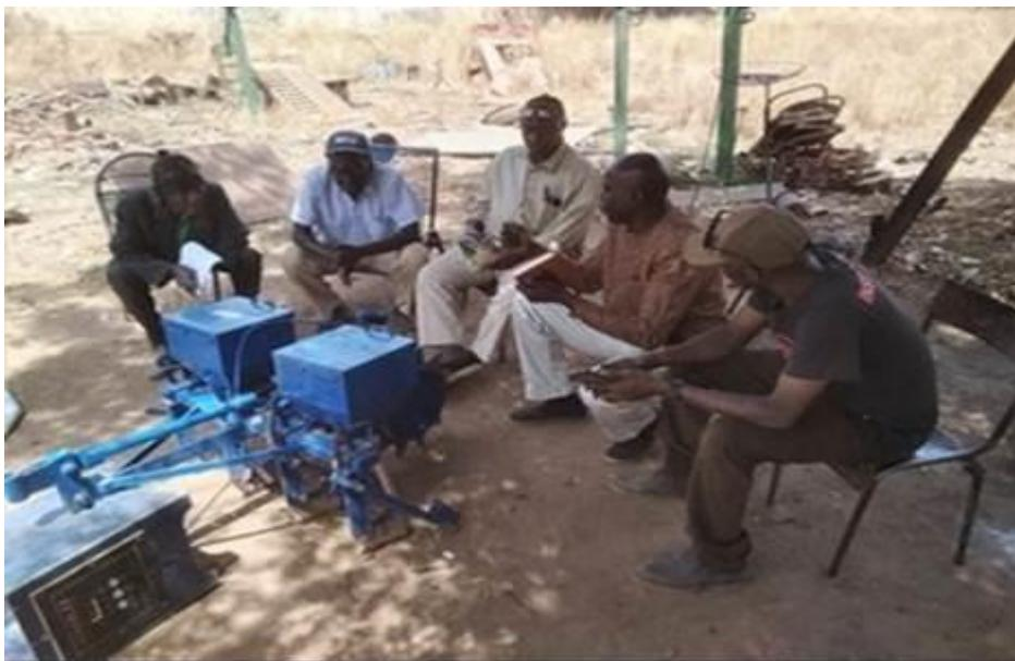
**Photo 27** : Un spécimen de semoir 4 rangs sur le riz
